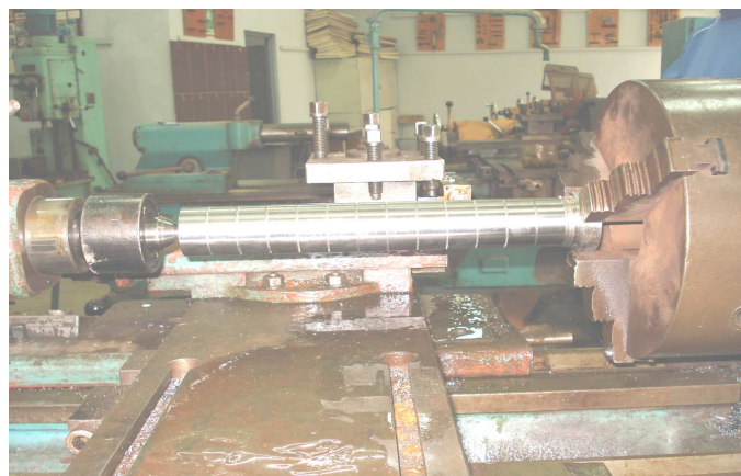
Figure II.14 Montage et préparation de l'éprouvette d'essai
