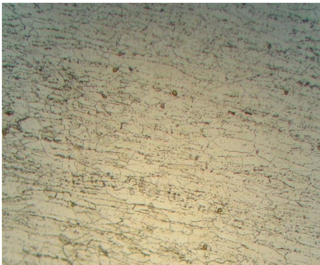
Figure 3.1.c Micrographie d'un échantillon déformé à 45%
