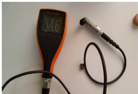
Figure IV.10. Appareil de mesure d'épaisseur par induction magnétique.
