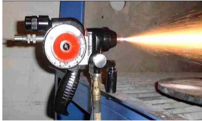
Figure IV.2 : Pistolet de projection à arc électrique « Arc spray 234 » ayant servi à la projection de l'acier inoxydable 304L et de l'alliage Ni-Al.
