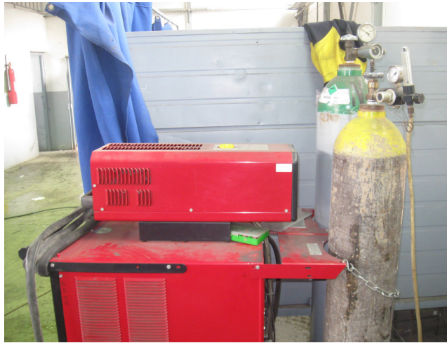
Figure 3. 6 : un poste de procédé de soudage TIG
