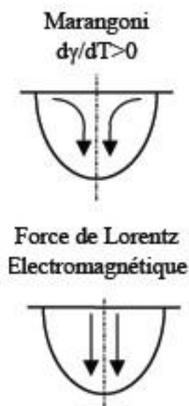
Figure 2.10 : Courants pénétrants dans le bain de fusion
