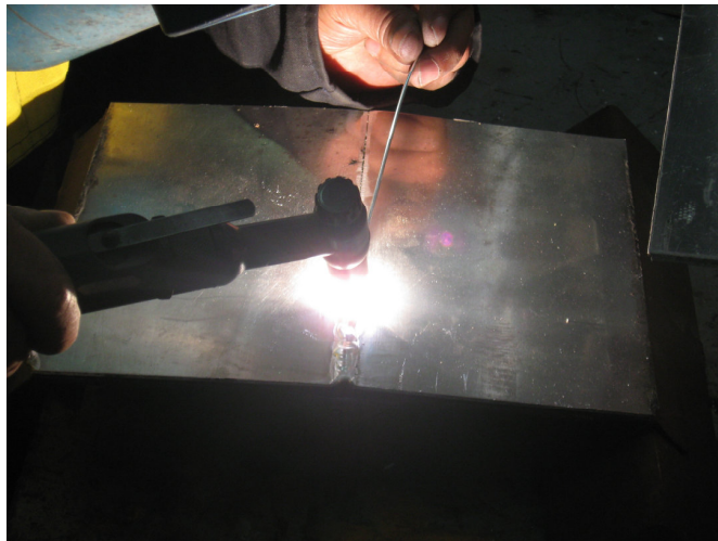
Figure 3.7 : application du procédé de soudage TIG
