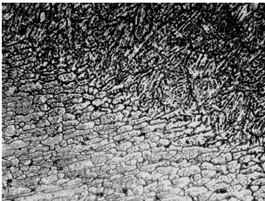
Figure 2.4 : microstructure de la ZAT et ZF séparant par une zone de liaison d'un alliage 7075 T6
