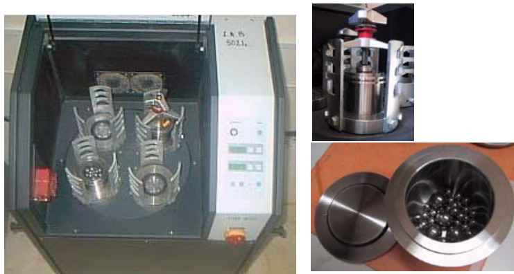
Figure 2.5: Broyeur planétaire, de marque commerciale Retsch PM 400 (modèle Pulvérisette 7), utilisé pour la mécanosynthèse des alliages.
