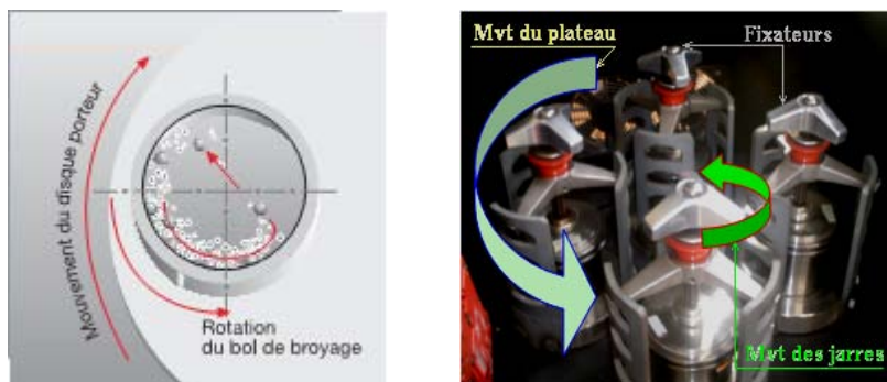
Figure.2.4 Présentation schématique du mouvement du plateau et des jarres.
