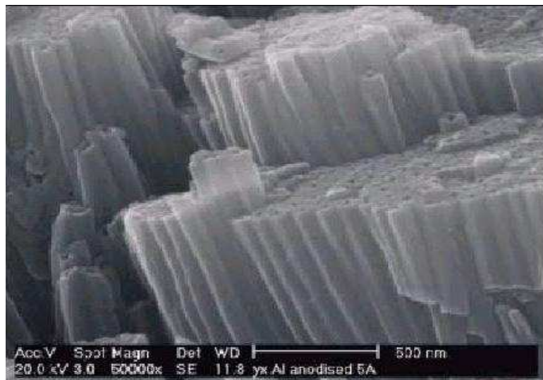
Figure I.1 : Structure longitudinale tubulaire de la couche d'anodisation poreuse non-colmatée [17]
