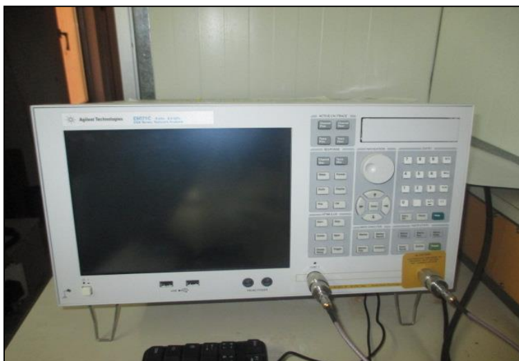
. Figure 30: Impédance mètre E5071C utilisé pour les mesures électriques.
